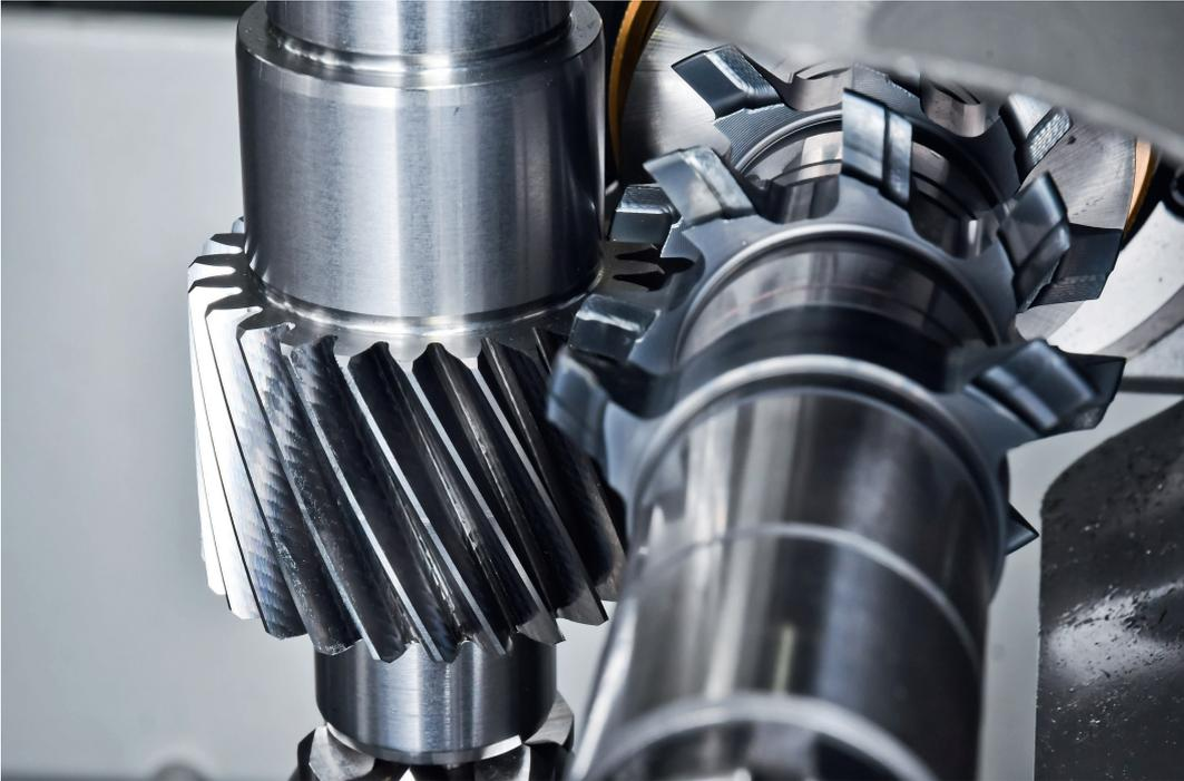
1 Das ChamferCut-CG-Verfahren ermöglicht ein Anfasen bis in den Zahngrund trotz Störkonturen
